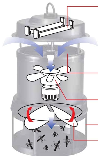
Due lampade a raggi UV emettono calore e luce ad una particolare lunghezza d'onda. La combinazione tra luce brillante e calore, risulta altamente attrattiva per le zanzare comuni. Lo specchio sopra le lampade moltiplica l'effetto luce.
